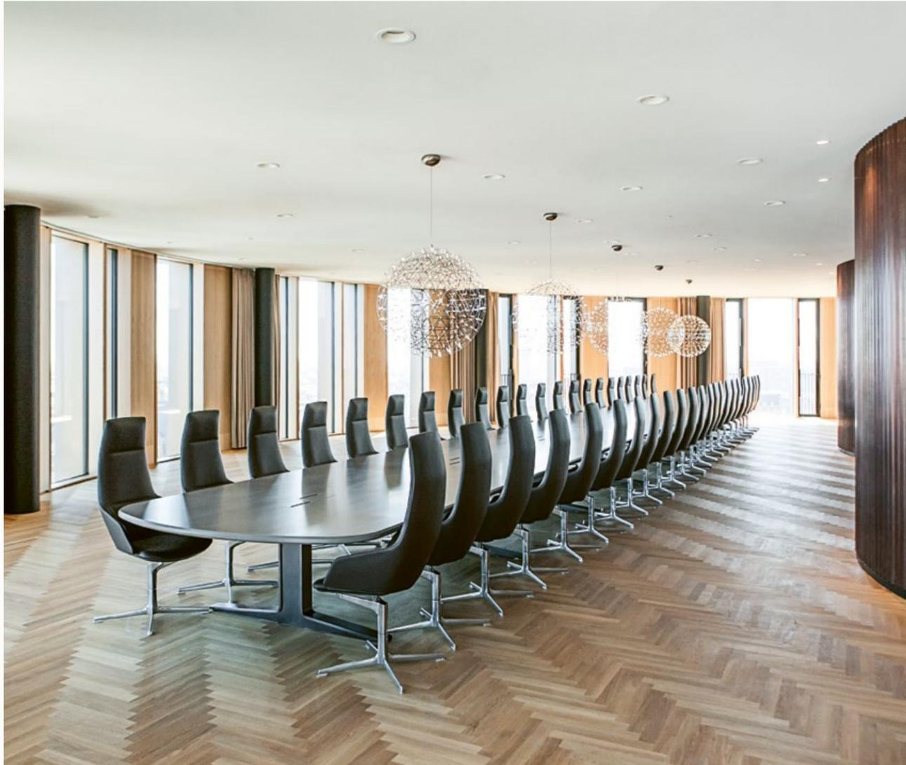
ZUNÄCHST wurde die eigens angefertigte Unterkonstruktion mit 8 Füßen aus pulverbeschichtetem Stahl aufgebaut, durch Laser vermessen und plan ausgerichtet. Dann haben Kunststoffspezialisten aus dem Münsterland einzelne Corian-Elemente aufgelegt, fixiert, verklebt, verspachtelt und akkurat feingeschliffen. Und zwar so lange geschliffen, bis das Material die gewohnte Mount Qualität freigegeben hat, mit einer wunderschönen, seidenmatten Oberfläche und dem handschmeichelndem Kantenprofil.
